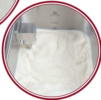
La lettura della quantità di miscela viene realizzata tramite un galleggiante che evita qualunque contatto ed attrito. La velocità di rotazione della girante varia in base alla quantità di miscela contenuta in vasca; sia minimi sia massimi vengono gestiti con la stessa efficacia, ottimizzando la prestazione della macchina.
